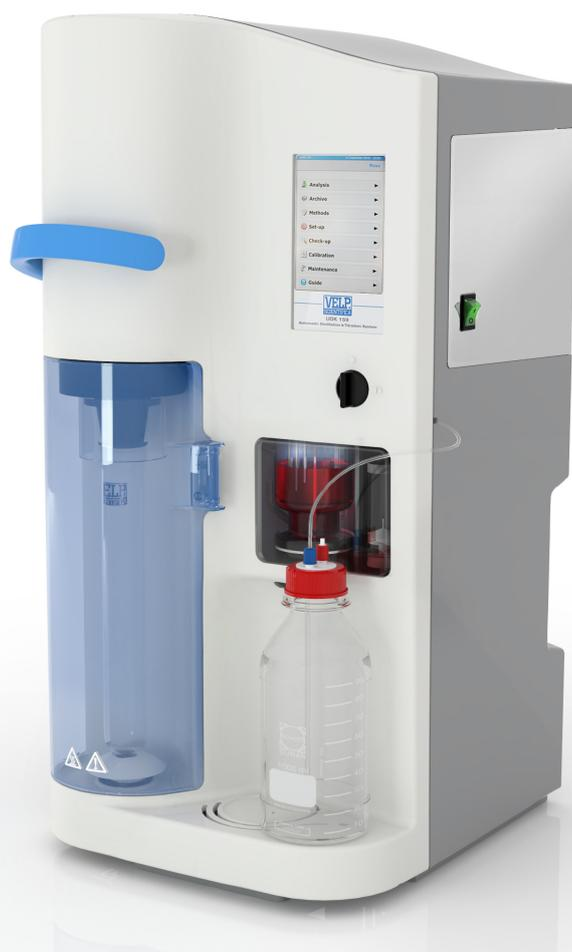
**UDK 159** – автоматический прибор для отгонки с паром и определения белка по Кьельдалю, разработанный Velp Scientifica.
