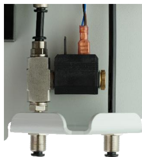
Рисунок: Электромагнитный клапан (бутылка с реагентом не установлена)
