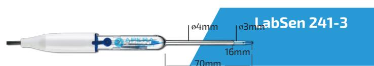
Микро-pH-электрод с футляром из нержавеющей стали защищает тонкий электрод от поломки. Подходит для измерения pH в микропланшетах и пробирках для центрифугирования (> 30 мкл).
