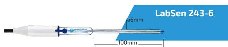
pH-электрод со встроенным датчиком температуры для автоматической температурной компенсации (АТС) обеспечивает быстрый и точный результат измерения pH образцов небольшого объема (> 0,2 мл).
